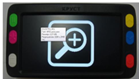
Электронный ручной видеоД-увеличитель со встроенным дисплеем предназначен для чтения плоскопечатного текста инвалидами с остротой зрения 0,03-0,1.
